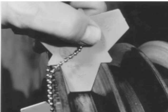
Gates Rillenlehren vereinfachen die Verschleißerkennung.
