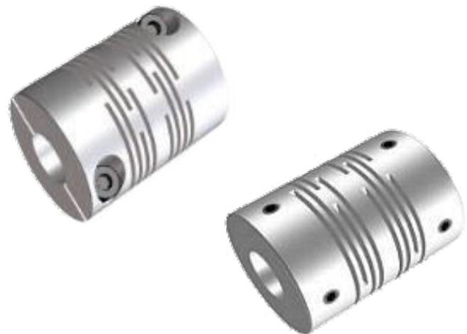
Die Mini-Kupplung wird aus hochwertigem Aluminium (Al), rostfreiem Stahl (VA) oder Automatenstahl (St) hergestellt. Sie ist für den Einsatz bei Temperaturen von  $-55\text{ °C}$  bis  $+150\text{ °C}$  uneingeschränkt geeignet. Auch höhere Temperaturen sind nach vorheriger technischer Abklärung möglich.
